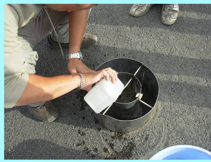
Prove LND tempo drenaggio
