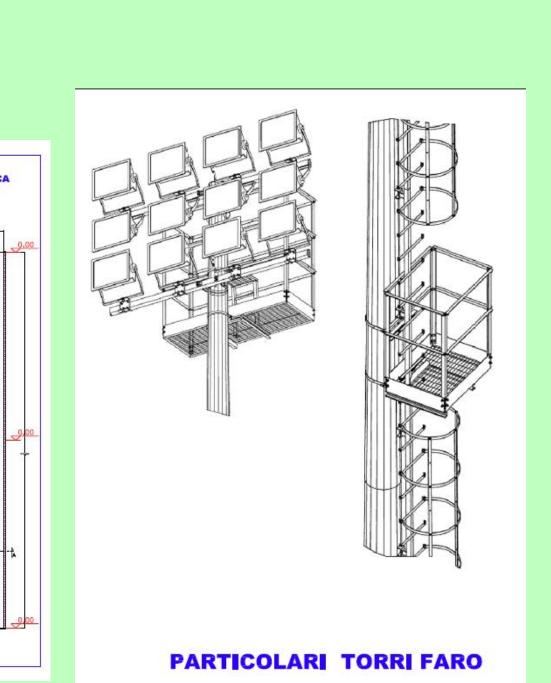
Conforme al requisiti UNI 12193 classe 2 Illuminam. Orizzontale 337 lux Min/Med 0,81
